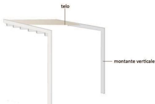
Pergola addossata: inclinata in ferro o alluminio verniciato a polveri con giunzione a spigolo vivo tra gamba e guida portante. A telo aperto senza traversi frontali è completamente libera di ostacoli.
