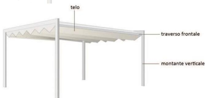
Pergola ad isola indipendente con struttura di sostegno in ferro o alluminio verniciato raccordata a spigolo vivo. Elemento di copertura con telo.
